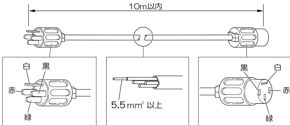
元電源には、漏電遮断器・アンペアブレーカを装備し、必ず、元電源はアースをとってください。尚、屋内配線工事は電気工事士の資格を持った人しかできませんので、電気工事店に依頼してください。
